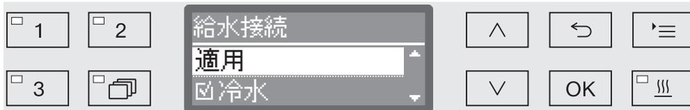
配管接続は、複数の選択肢を介して設定されます。ボックス  がすべての配管接続の横に表示されます。接続が有効になっている場合、ボックスにチェックマーク  が表示されます。有効化/無効化する配管接続を選択します。
