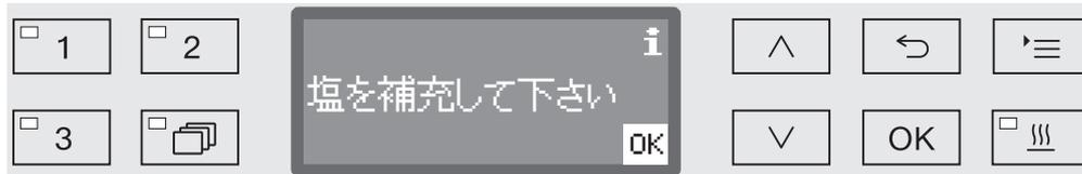
システムメッセージはプログラムの開始時と終了時に表示され、OKを使用して個別に確定（確認）するか、プログラムの終了時にドアを開けてまとめて確定（確認）する必要があります。ディスプレイに**i**の記号が表示されている場合、OKボタンを押すとシステムメッセージを開くことができます。
