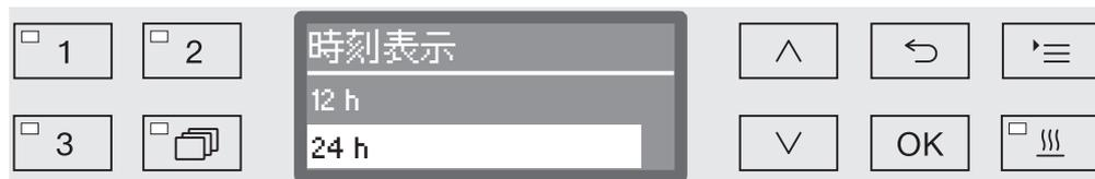
■ ^ および V 矢印ボタンを用いて希望の時計形式を選択し、OK を押して保存します。
