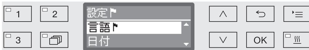
操作パネルの△と▽矢印ボタンを使用して、メニューをナビゲートします。
