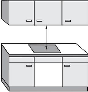
Entre la placa y una campana extractora colocada encima se deberá mantener la distancia de seguridad indicada por el fabricante de la campana.
