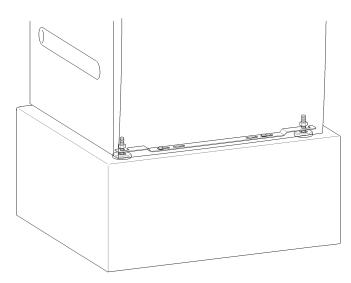
Mit dem beiliegenden Befestigungsbügel wird das Gerät über die beiden vorderen Standfüße am Boden befestigt. Das Befestigungsmaterial ist für eine Dübel-Befestigung auf Betonboden ausgelegt.
