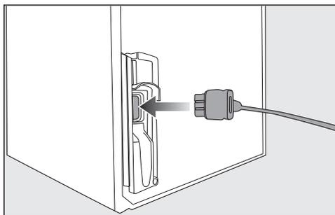
■ Τοποθετήστε το φις της συσκευής στην πίσω πλευρά του ψυγείου.
