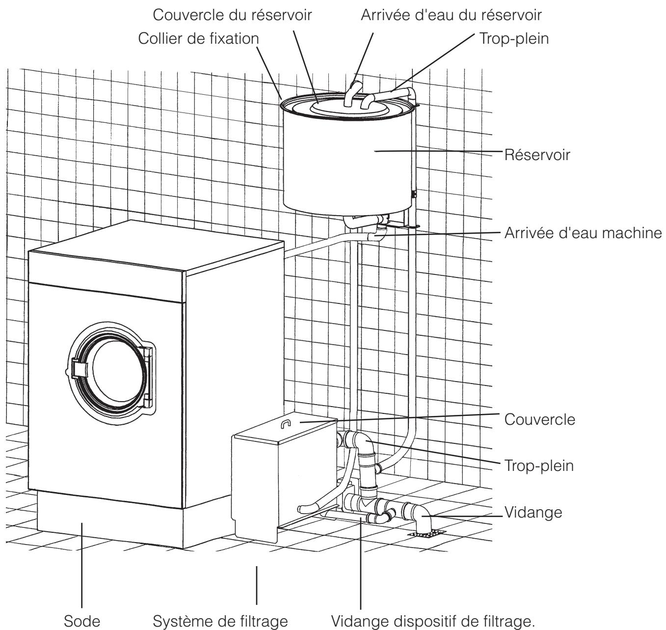
La première installation ne doit être effectuée que par le service après-vente ou un revendeur agréé.
