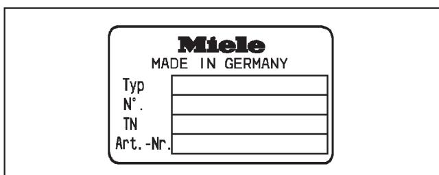
Serwis wymaga podania typu, numeru urządzenia (N°) i numeru części (TN). Dane te znajdują się na tabliczce znamionowej.
