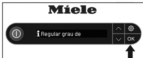
A mensagem no visor **i** Regular grau de dureza da água... tem de ser primeiramente confirmada ao premir a tecla OK antes de poder configurar o nível de dureza da água.
