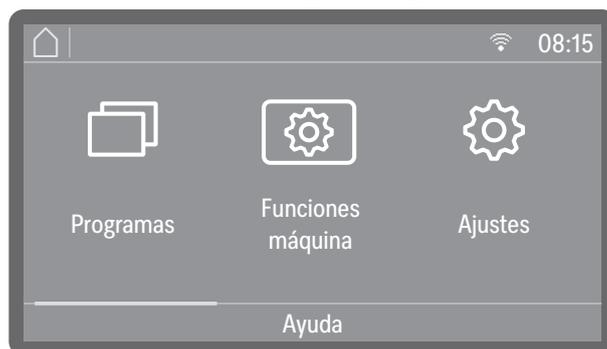
En el caso de lavadoras desinfectadoras con conectividad, en la parte superior del display aparece el icono de la interfaz disponible. 📶 significa que hay conexión WiFi disponible; L significa que existe una conexión LAN por cable. Si la lavadora desinfectadora no puede establecer una conexión WiFi con el router, el símbolo aparece tachado 📶.
