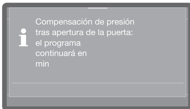
Si la temperatura en el interior de la cuba supera en ese momento los 60 °C, se producirá antes una compensación de la presión. Después, el programa continuará
