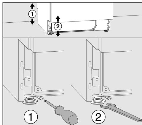
Las patas delanteras del aparato pueden ajustarse con una llave de boca (tamaño de llave 13); las traseras, con un tornillo Torx T20. Si no se montan los patines deslizantes de las patas traseras, también pueden regularse las patas del aparato con la llave de boca. La regulación hacia arriba se efectúa girando hacia la derecha y hacia la izquierda para la regulación hacia abajo.
