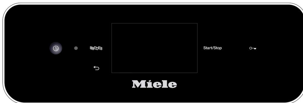
El manejo se realiza normalmente a través del panel de mandos, que incluye un display táctil y varias teclas (teclas sensoras).
