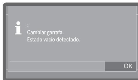
Los mensajes del sistema se indican con el símbolo **i**. Proporcionan información sobre el proceso en curso y el estado del aparato. Si hay varios mensajes del sistema, estos se emiten sucesivamente y deben procesarse o confirmarse individualmente según el mensaje.
