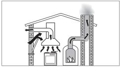
Pericolo di intossicazione a causa dei gas combustibili. Se la cappa viene messa in funzione sul luogo di installazione ed è attivo un fuoco (fiamma) alimentato con aria ambiente, è necessario adottare delle precauzioni.
