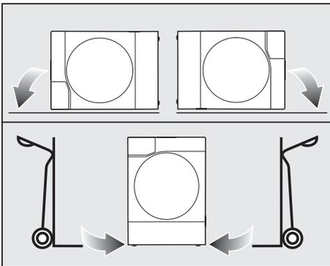
■ Transportieren Sie die Waschmaschine nur über die linke oder rechte Seitenwand:
