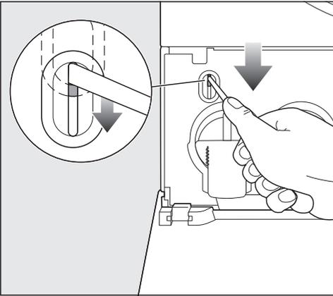
1. Drücken Sie den Entriegelungsmechanismus der Tür mit Hilfe eines Schraubendrehers ganz nach unten, ohne dass Sie die Tür berühren oder öffnen.
