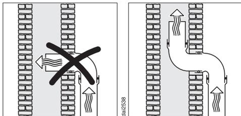
Si l'air doit être évacué dans une cheminée d'évacuation, le manchon d'entrée doit être orienté dans le sens du flux d'air.
