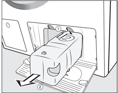
① Um die Verriegelung zu lösen, drücken Sie den gelben Knopf oberhalb der Kartusche.
