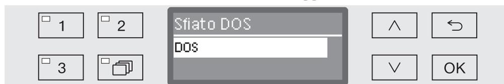
Con la selezione del sistema di dosaggio si avvia lo sfiato automatico. Una volta avviato, il processo dello sfiato automatico non può più essere interrotto.
