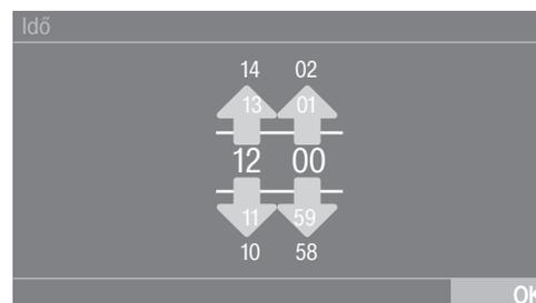
A számokat felfelé vagy lefelé simítással adja meg. Helyezze az ujját a módosítandó számjegyre, és mozgassa az ujját a kívánt irányba. Az *OK* érintőgombbal a beállított számérték rögzítésre kerül.
