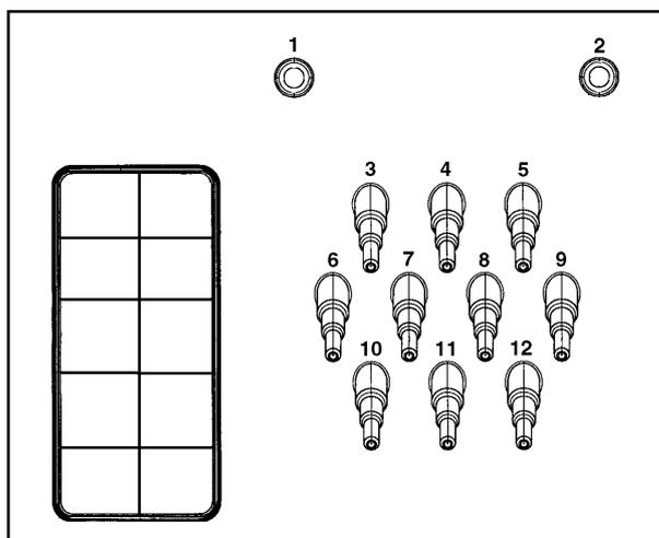
Přípojky **1** a **2** jsou určeny pro dávkování gelových prostředků. Tato přípojovací hrdla jsou uzavřená a musí být provrtána vrtákem o průměru 8 mm.
