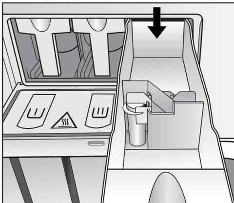
Tekuté bělidlo se smí dávat jen do dávkovacího zásobníku, který je pro ně určený. Jen tehdy je zajištěno, že se prostředek ve 2. máchání automaticky správně vypláchne. Přidávání tekutých bělidel u barevného prádla nevzbuzuje pochybnosti jen tehdy, když výrobce textilie na etiketě pro ošetřování poukazuje na stálobarevnost a bělení výslovně povoluje.
