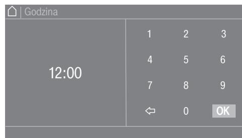
Po wprowadzeniu prawidłowej wartości przycisk dotykowy OK zostaje zaznaczony na zielono.
