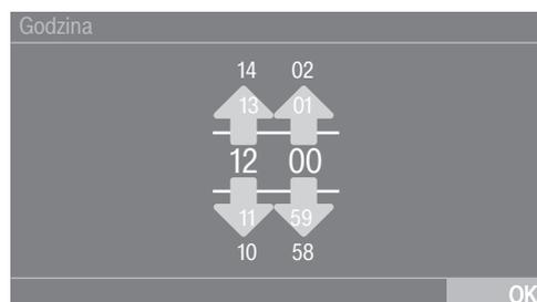
Wprowadzić liczby przez przeciąganie do góry lub do dołu. Położyć palec na cyfrze do zmiany i przesunąć palec w wybraną stronę. Naciśnięcie przycisku dotykowego **OK** spowoduje zaakceptowanie ustawionej wartości liczbowej.
