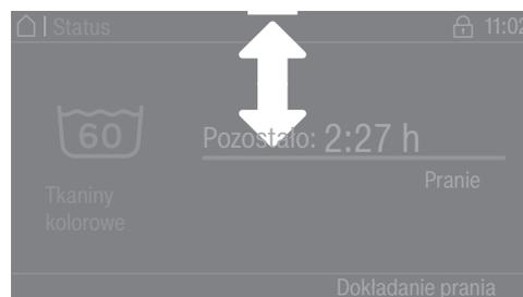
Gdy na górnej krawędzi ekranu pośrodku wyświetlacza pokazywany jest pomarańczowy pasek, można wówczas wyświetlić wysuwane menu. Dotknąć pasek i przeciągnąć palec po wyświetlaczu do dołu.
