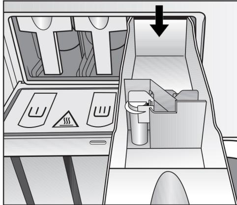
A folyékony fehérítő szerek hozzáadása csak az egy arra tervezett beöblítő fiókon keresztül történhet. Csak akkor biztosított, hogy a szer automatikusan a mosásnak megfelelően a 2. öblítési menetben kerül beöblítésre. A folyékony fehérítőszer adagolása színes ruháknál, ha a textília gyártója az ápolási jelölésekben a szintartóságra utal és a fehérítéshez kifejezetten hozzájárul.
