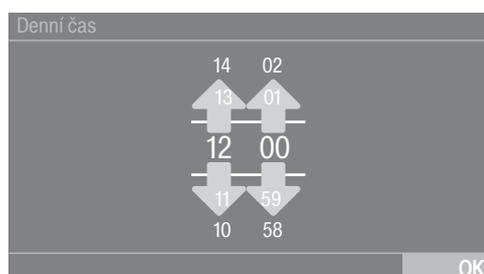
Čísla zadávejte tažením nahoru nebo dolů. Položte prst na číslici, kterou chcete změnit, a pohybujte jí požadovaným směrem. Senzorovým tlačítkem *OK* se nastavená číselná hodnota převezme.
