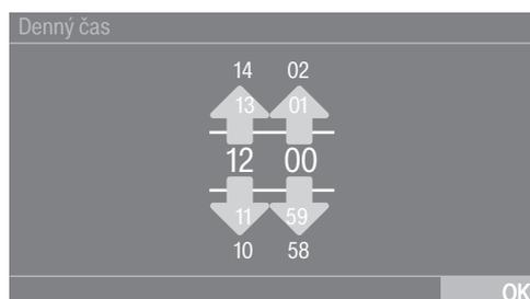
Čísla zadávajúte potiahnutím smerom hore alebo dole. Položte prst na číslicu, ktorú chcete zmeniť a pohybujte ním do želaného smeru. Senzorovým tlačidlom *OK* sa nastavená číselná hodnota prevezme.
