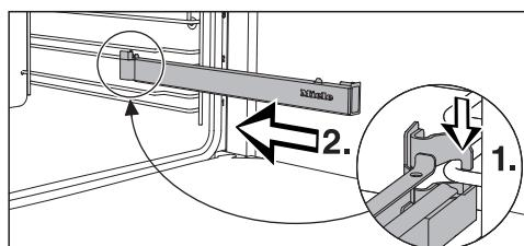
■ Prenda a calha telescópica FlexiClip à frente na guia inferior de um nível de encaixe (1.º) e deslize-a ao longo dessa guia para o interior do forno (2.º).
