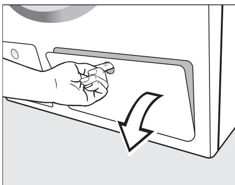
■ Для открывания потяните крышку отсека системы TwinDos.
