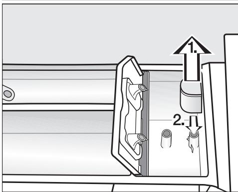
1. Вытяните сифон из ячейки ⊗ и промойте под струёй тёплой воды. Также вымойте трубку, на которой находится сифон.
