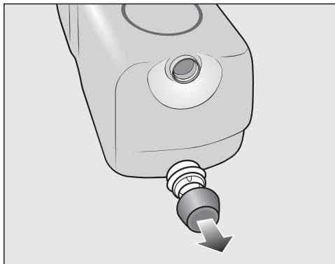
■ Снимите плёнки с поставляемых в комплекте с прибором картриджей с моющим средством **UltraPhase 1**.
