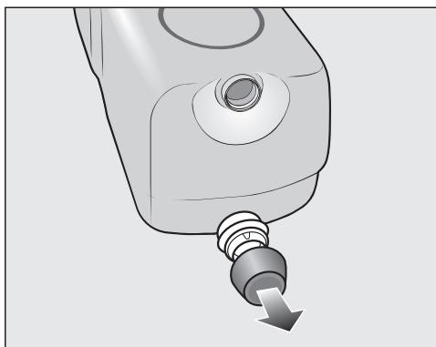
■ Снимите пробку с картриджа.
