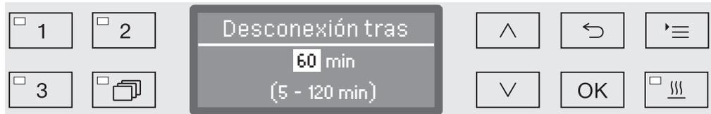
La tiempo de espera se puede ajustar en pasos de 5 minutos. En la línea inferior se indica el rango de ajuste permitido.
