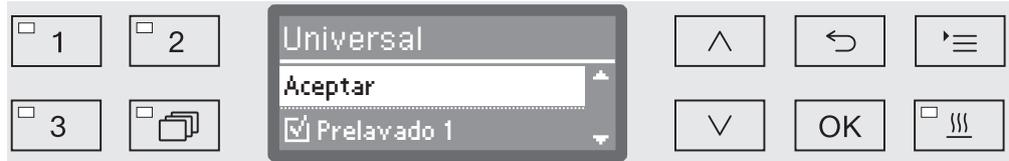
La asignación se efectúa mediante selección múltiple. En la indicación del display todos los bloques de lavado van precedidos por una casilla . Si el bloque de lavado está asignado a un programa, se verá una marca de verificación . Al seleccionar los bloques de lavado, estos se pueden asignar al programa o se puede volver a eliminar la asignación.
