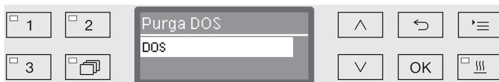
Al seleccionar el sistema de dosificación se inicia la purga automática. Una vez iniciada, ya no se podrá interrumpir el proceso de purga automática.
