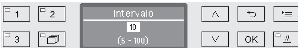
El ajuste se realiza en pasos de a 5. En la línea inferior se indica el rango de ajuste permitido.
