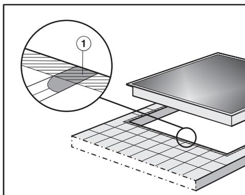
La surface des joints ① et de la partie hachurée située sous la surface d'appui de la table de cuisson doit être lisse et parfaitement plane de sorte que la table de cuisson repose bien à plat et que la bande d'étanchéité insérée sous le bord de la partie supérieure de l'appareil assure une bonne étanchéité par rapport au plan de travail.
