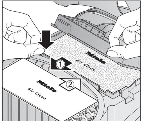
2. Wenn Sie anstelle des Abluftfilters **b** oder **c** einen Abluftfilter **a** einsetzen, müssen Sie diesen Abluftfilter unbedingt in ein Filtergitter\* einlegen.
