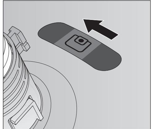
Tauschen Sie den Staubsaugerbeutel, wenn die Farbskala das Sichtfenster der Staubsaugerbeutel-Wechselanzeige rot ausfüllt.
