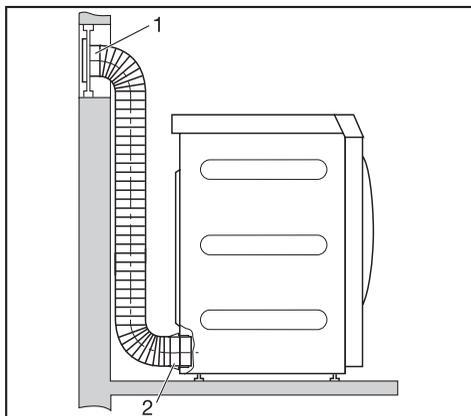
1. Raccordement à une fenêtre (intégrée dans une vitre en plexiglas) (une notice est fournie avec le raccordement à une fenêtre Miele)
