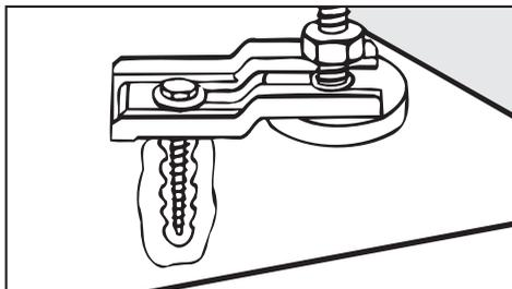
⚠ Dans les cas suivants, le sèche-linge **doit** être bloqué au niveau des pieds avec des pattes de fixation\* (accessoires en option).
