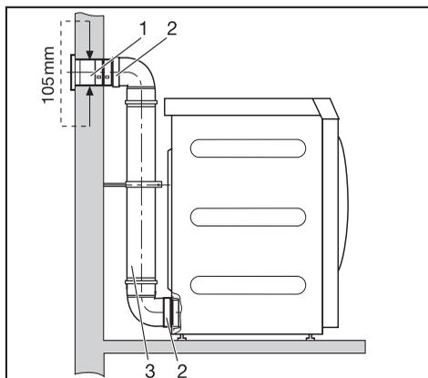
1. Tuyau à encastrer dans le mur (une notice de montage est fournie avec le tuyau Miele)
