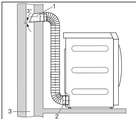
1. Tuyau avec raccord (= pièces individuelles constituant le tuyau à encastrer dans le mur Miele)
