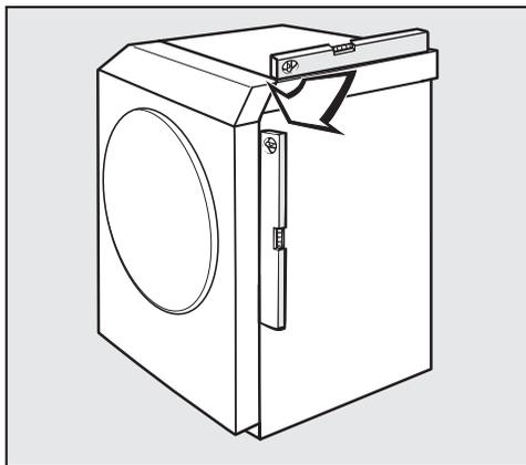
⚠ Le sèche-linge doit être d'aplomb afin de fonctionner parfaitement.
