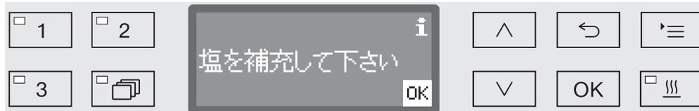
システムメッセージはプログラムの開始時と終了時に表示され、OKを使用して個別に確定（確認）するか、プログラムの終了時にドアを開けてまとめて確定（確認）する必要があります。ディスプレイに**i**の記号が表示されている場合、OKボタンを押すとシステムメッセージを開くことができます。
