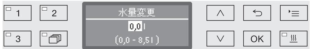
水量は0.5 l単位で増やすか、または工場出荷時設定の量に戻すことができます。可能な範囲が最下行に表示されます。設定「0 l」は、工場出荷時設定と同じです。
