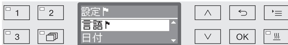
操作パネルの^とv矢印ボタンを使用して、メニューをナビゲートします。
