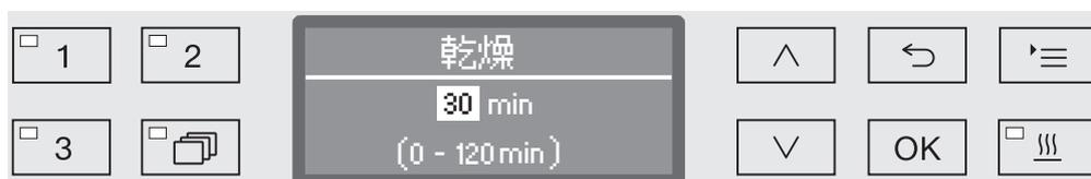
時間が変更可能として設定されている場合、このプログラムのプリセット乾燥時間はディスプレイに分 (min) で表示され、可能な設定範囲が一番下の行に表示されます。
