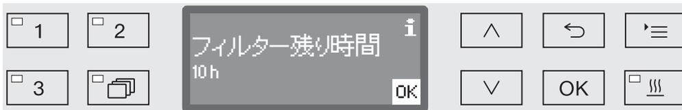
このフィルタータイプの残りの運転時間は、ディスプレイに表示されます。
