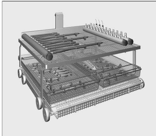
上段には、すすぎや吸引のハンドピース、カニューレのような内腔を持つ器具を再生処理するためのさまざまな接続部が取り付けられています。モバイルインジェクターユニットの下段は、内腔のない器具を再生処理するためのインサートとメッシュトレイが入るように設計されています。
