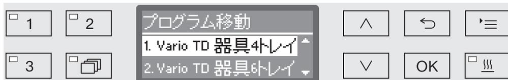
リリースされたプログラムはすべてプログラムリストに表示されます（「拡張設定/プログラムリリース」を参照）。プログラムリスト内のプログラムの位置は、プログラム選択ボタンの割り当てに決定的となります。プログラムには1 - nの番号が付けられています。リストの最初の3つのプログラムは、プログラム選択ボタンに割り当てられます。例：
