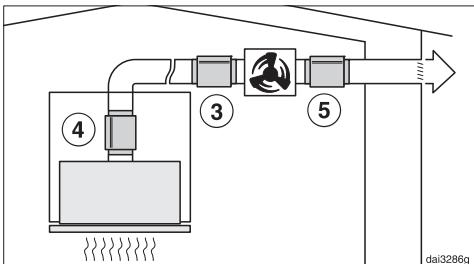
Kod načina rada s vanjskim ventilatorom, zvukovi ventilatora se mogu smanjiti prema van i u kuhinji.
