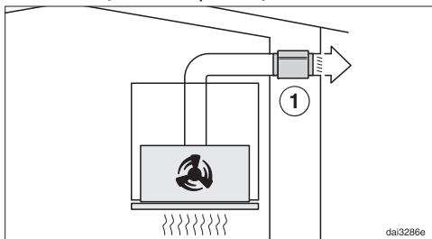
Kod načina rada na odvod zraka, prigušivač buke prigušuje kako zvukove ventilatora prema van tako i vanjske zvukove, koji putem cijevi za odvod zraka prodiru u kuhinju (npr. ulična buka). Stoga se prigušivač buke postavlja što je moguće bliže izlaza zraka (1).
