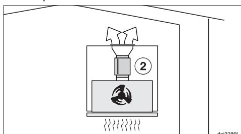
Kod načina rada na kruženje zraka, prigušivač buke se postavlja između ispušnog otvora i ispušne rešetke (2). Provjerite prostor ugradnje.
