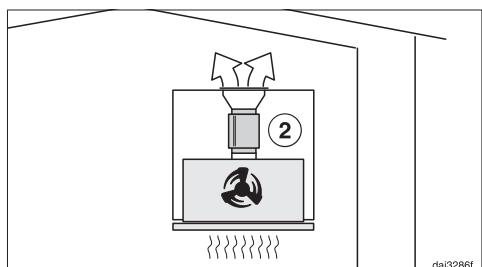
Στη λειτουργία ανακύκλωσης αέρα ο σιγαστήρας τοποθετείται ανάμεσα στο στόμιο εξαγωγής αέρα και τη σκάρα εξαερισμού ②. Ελέγχετε τον χώρο τοποθέτησης.
