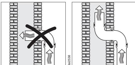
Αν ο εξερχόμενος αέρας οδηγείται σε καπνοδόχο εξαγωγής αέρα, το στόμιο εισαγωγής πρέπει να είναι στραμμένο προς την κατεύθυνση του ρεύματος.
