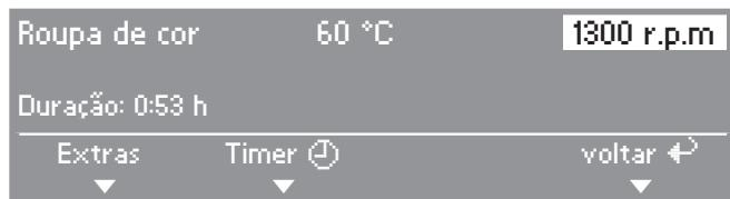
Rodando o selector multifunções pode seleccionar os diferentes componentes do programa, programa, temperatura e velocidade de centrifugação.
