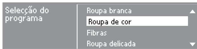
Através do selector multifunções pode seleccionar todos os programas existentes. A marcação movimenta-se para cima ou para baixo conforme o sentido de rotação.
