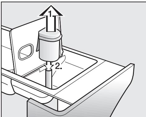
Se utilizar com frequência goma líquida ou produto amaciador efectue a limpeza do tubo de sucção e do canal de passagem. Goma líquida tem tendência a colar.
