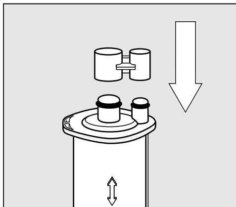
**Savjet:** Kartušu za uklanjanje kamenca možete zatvoriti s poklopcom, koji se nalazi na cilindru kartuše. Poklopac se jednostavno može ukloniti na za to predviđenom mjestu.
