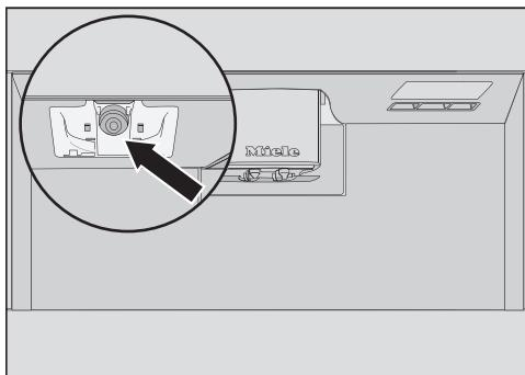
■ Prihvati boce za mlijeko na aparatu za kavu očistite s vlažnom spužvastom krpom.
