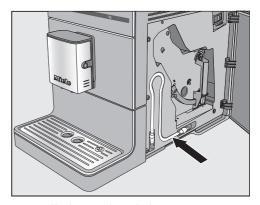
**Conseil :** le conduit de lait peut être rangé derrière la trappe de l'appareil s'il n'est pas utilisé.
