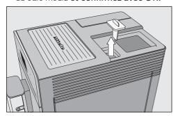
Retirez le couvercle du réservoir à grains puis celui du compartiment à café moulu. Versez **12 g max.** dans le compartiment à café moulu.
