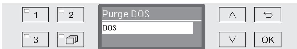
La purge automatique démarre dès qu'on sélectionne le système de dosage. Une fois démarré, le processus de purge automatique ne peut plus être interrompu.
