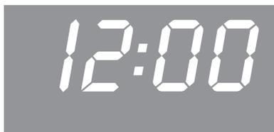
Après le raccordement au réseau électrique, *12:00* clignote à l'écran.
