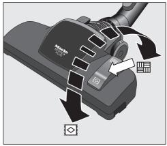
伸出除塵刷清潔平滑而不易刮花的堅硬 地板,以及有罅隙或深縫的地板:
