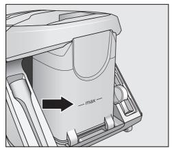
■ 在灰塵達到集塵器上的**最大**容量標記 之前,清空集塵器。
