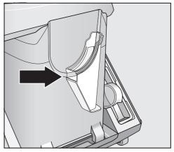
可拆除的預過濾網框架位於集塵器內。 如果明顯髒污,應進行清潔。
