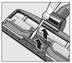
■ 從插槽中拆出撿線器。可以使用合適 的工具,例如一字螺絲批。
