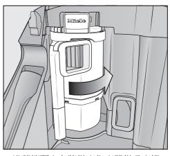
■ 沿著箭頭方向將微塵集塵器從吸塵機 中鬆開並移除。
