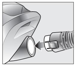
■ 將吸喉連接器插入吸塵機的吸氣口, 直至其卡入就位。首先將兩個部分的 指示線對齊。
