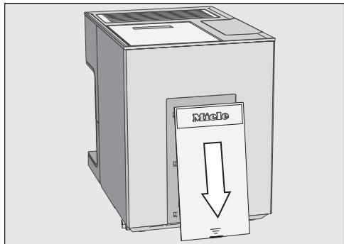
■ Снимите крышку, находящуюся с обратной стороны кофемашины.
