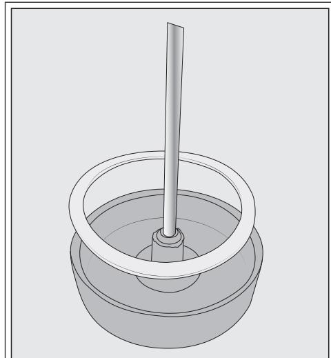
При необходимости с крышки ёмкости для молока можно снять соединительный элемент и уплотнительное кольцо. Чтобы снять трубку из нержавеющей стали, слегка выдавите соединительную деталь из внутренней части крышки.
