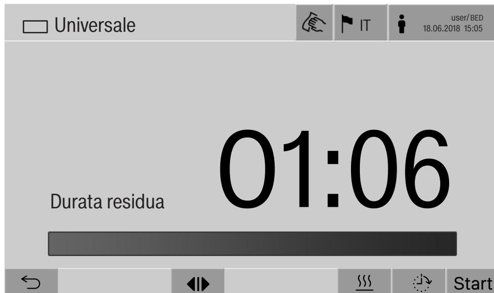
Dopo aver selezionato il programma viene visualizzata la durata residua del programma di trattamento scelto. Se il parametro *Visualizzare durata residua* nell'interfaccia web non è attivato, dopo l'avvio del programma l'indicazione passa alla *Durata già trascorsa* del programma.
