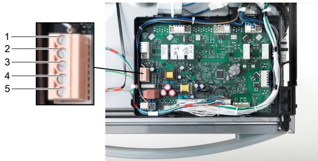
**Nasvet:** Največja dovoljena poraba električnega toka na priključni letvi: 0,5 A. Prikložite le zunanje dozirne naprave, ki imajo lastno varovalko. Vključite dozirno napravo v sistem z zaščitnim vodnikom (PE) pomivalnega stroja.
