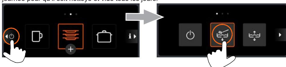
Appuyer sur le bouton de démarrage/d'arrêt pour éteindre le lave-vaisselle. La cuve reste remplie, mais la température n'est pas maintenue. Si la température de la cuve baisse trop avant la prochaine mise en service, la machine est automatiquement vidée et à nouveau remplie.
