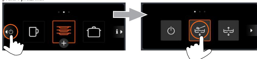
Perilica se isključuje pritiskanjem tipke za uključivanje/isključivanje. Spremnik ostaje napunjen, no ne zadržava se više na istoj temperaturi. Ako se temperatura spremnika do sljedećeg uključivanja previše smanji, perilica će se automatski isprazniti i ponovno napuniti.
