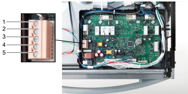
**Υποδειξις:** μέγιστη κατανάλωση ρεύματος στη γραμμή παράδοσης: 0,5 A. Συνδέστε μόνο εξωτερικές συσκευές δοσομέτρησης που διαθέτουν δική τους ασφάλεια παροχής. Συμπειλάβετε τη συσκευή δοσομέτρησης στο σύστημα γείωσης (PE) του πλυντηρίου πιάτων.
