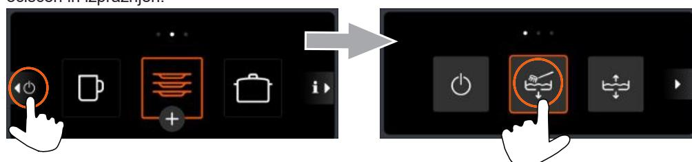
Če pritisnete tipko za vklop/izklop, se pomivalni stroj izklopi. Rezervoar ostane napolnjen, vendar se temperatura ne vzdržuje. Če temperatura pomivanja do naslednjega vklopa preveč upade, se stroj samodejno izprazni in znova napolni.
