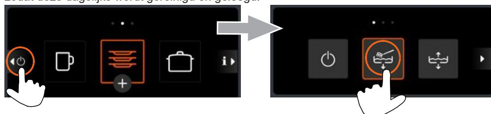
Door op de in-/uitschakeltoets te drukken, wordt de vaatwasmachine uitgeschakeld.<sup>1</sup> De tank blijft gevuld maar wordt niet meer op temperatuur gehouden. Als de tanktemperatuur te sterk is gedaald wanneer de machine de volgende keer opnieuw wordt ingeschakeld wordt de machine automatisch leeggepompt en opnieuw gevuld.
