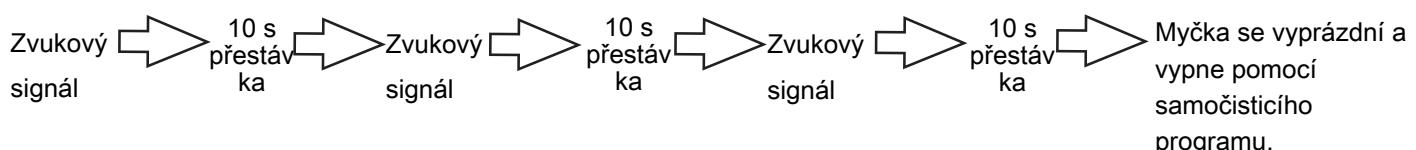
Když jsou dveře v okamžiku automatického vypnutí otevřené, myčka se vyprázdní a vypne, ale uvnitř se nevyčistí.
