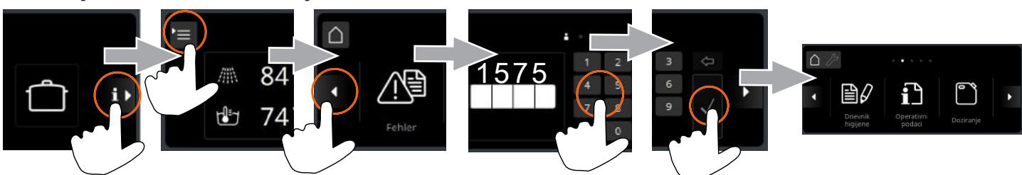
Izbornik je PIN-om zaštićen od neovlaštena pristupa. PIN glasi 1575. Ako se PIN triput zaredom pogrešno unese, daljnji se unos blokira na 10 minuta.
