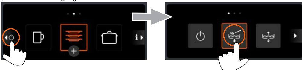
Premendo il tasto di accensione/spegnimento la lavastoviglie si spegne. La vasca rimarrà piena ma non si manterrà in temperatura. Se prima della successiva accensione la temperatura della vasca scende eccessivamente, la macchina si svuota e si riempie di nuovo automaticamente.
