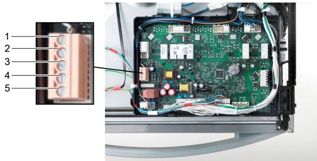
**Hinweis: maximale Stromentnahme an der Übergabeleiste: 0,5**
