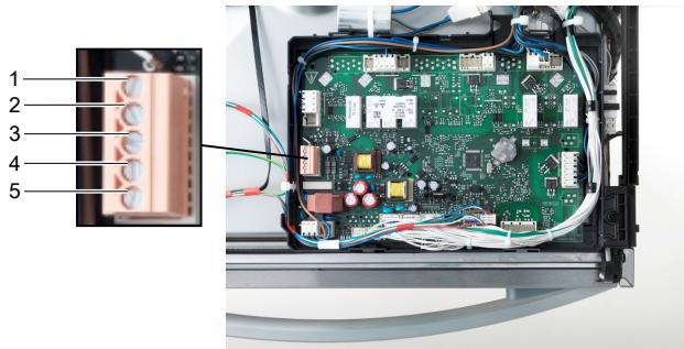
**Aanwijzing: Maximale stroomafname op de doorverbindingssstrip: 0,5 A. Gebruik alleen externe doseersystemen met een eigen afzegering. Doseersysteem in het beveiligingssysteem (PE) van de vaatwasmachine integreren.**
