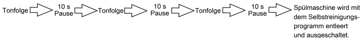
Wenn die Tür zum Zeitpunkt des automatischen Ausschaltens geöffnet ist, wird die Spülmaschine leer gepumpt und ausgeschaltet, aber innen nicht gereinigt.
