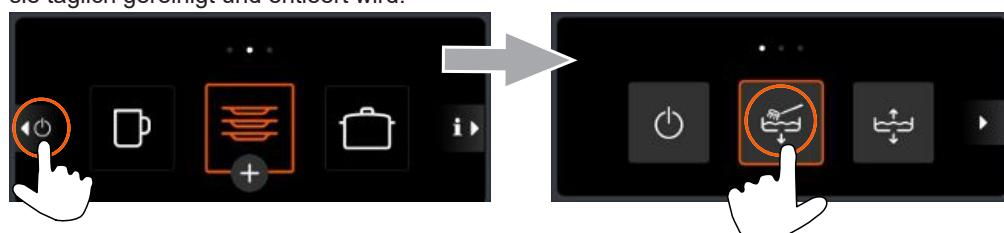
Das Drücken der Ein-/Ausschalttaste schaltet die Spülmaschine aus. Der Tank bleibt gefüllt, wird jedoch nicht mehr auf Temperatur gehalten. Wenn die Tanktemperatur bis zum nächsten Einschalten zu stark abfällt, wird die Maschine automatisch entleert und neu gefüllt.
