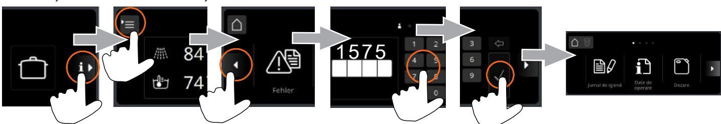
Meniul este protejat împotriva accesului neautorizat cu ajutorul unui cod PIN. Codul PIN este 1575. Dacă introduceți PIN-ul de trei ori greșit, introducerea în continuare este blocată timp de 10 minute.
