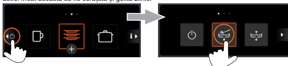
Apăsarea tastei de conectare/deconectare oprește mașina de spălat vase. Rezervorul rămâne în continuare plin, dar nu va mai fi menținută temperatura. Dacă temperatura din rezervor scade prea mult până la următoarea pornire, mașina este golită automat și reumplută.
