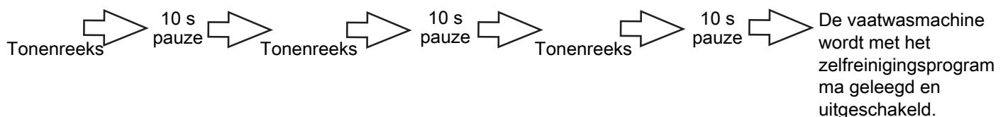
Wanneer de deur open is op het moment dat de vaatwasmachine automatisch wordt uitgeschakeld, wordt de vaatwasmachine leeggepompt en uitgeschakeld, maar niet inwendig gereinigd.
