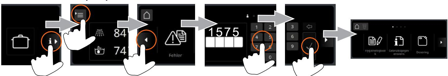
Het menu is met een PIN beveiligd tegen toegang door onbevoegden. De PIN is 1575. Als de PIN drie keer op rij verkeerd is ingevoerd, wordt het invoeren 10 minuten lang geblokkeerd.
