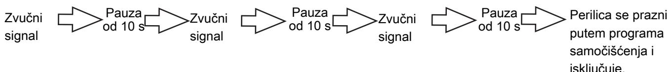
Ako su vrata u trenutku automatskog isključivanja otvorena, perilica se u potpunosti prazni i isključuje, ali se ne čisti iznutra.
