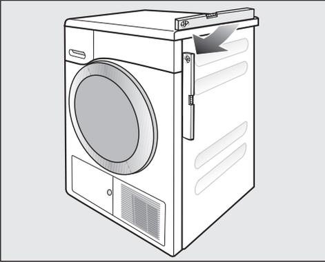
Для обеспечения правильной эксплуатации сушильная машина должна быть выровнена по вертикали. Вращением винтовых ножек сушильной машины можно компенсировать неровности пола.
