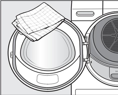
■ Для очистки сушильной машины и уплотнения на внутренней стороне дверцы достаточно использовать влажную мягкую салфетку, смоченную мягким моющим средством или мыльным раствором.
