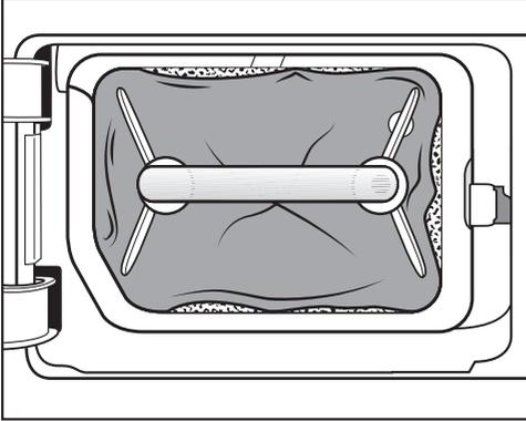
Края цокольного фильтра прилегают неплотно, и он деформируется. В местах, где края фильтра прилегают неплотно, в теплообменник попадает ворс. По этой причине теплообменник сильно засоряется, что приводит к повреждению прибора.
