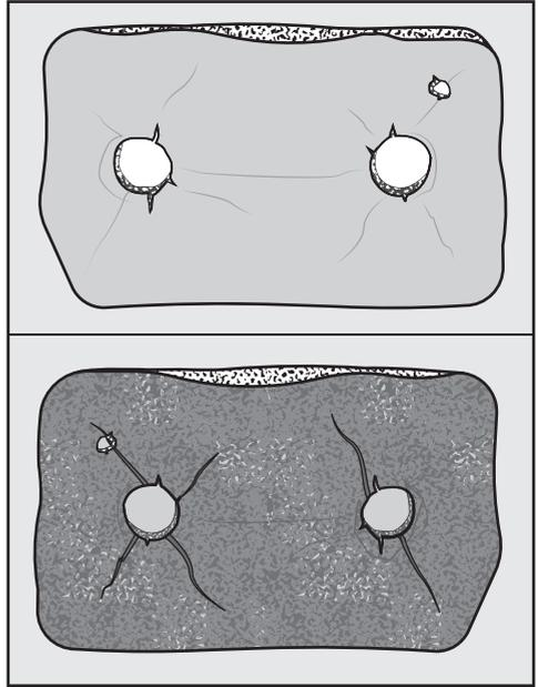
Через разрывы и трещины ворс попадает в теплообменник. По этой причине теплообменник сильно засоряется.
