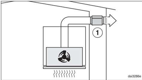
Bei Abluftbetrieb dämpft der Schalldämpfer sowohl Gebläsegeräusche nach aussen als auch Aussengeräusche, die über die Abluftleitung in die Küche dringen (z. B. Strassenlärm). Dazu wird der Schalldämpfer möglichst nah vor dem Abluftaustritt ① positioniert.
