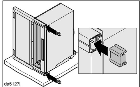
■ Stecken Sie die Tiefenanschläge von hinten in die Auszüge des Wrasenschirms. Die Lippe des Tiefenanschlages weist nach hinten.
