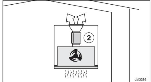
Bei Umluftbetrieb wird der Schalldämpfer zwischen Ausblasstutzen und Ausblasgitter positioniert ②. Prüfen Sie den Einbauraum.
