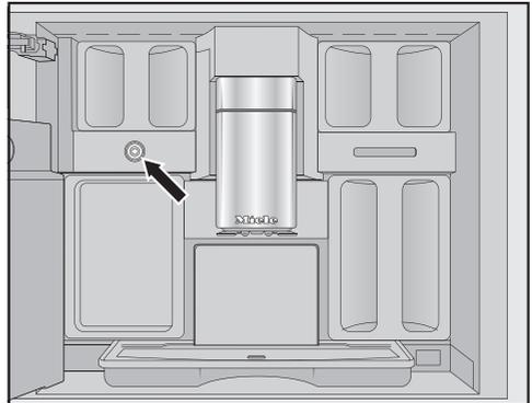
Das Milchventil befindet sich unter dem linken Bohnenbehälter.
