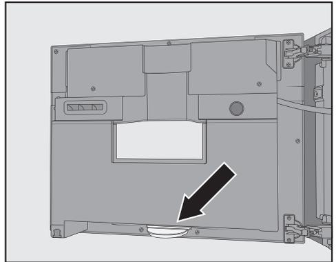
Unten an der Innenseite der Gerätetür befindet sich die Tropfschale.
