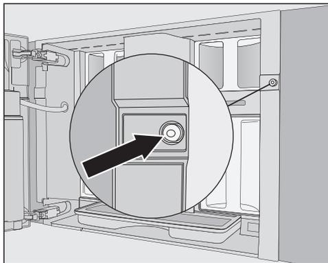
In dem Schraubenloch befindet sich eine rote Silikonknetpe, die die Gerätetür während des Transports sichert und so Transportschäden am Gerät verhindert.
