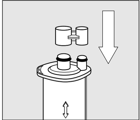
**Tipp:** Sie können die Entkalkungskartusche mit der Kappe verschliessen, die sich am Kartuschenzylinder befindet. Die Kappe lässt sich leicht an der Sollbruchstelle lösen.
