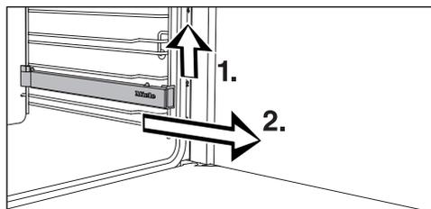
■ 从前面抬起 FlexiClip 灵动滑轨，将其拆下 (1.)，然后沿着搁架层轨道向前拉出 (2.)。
