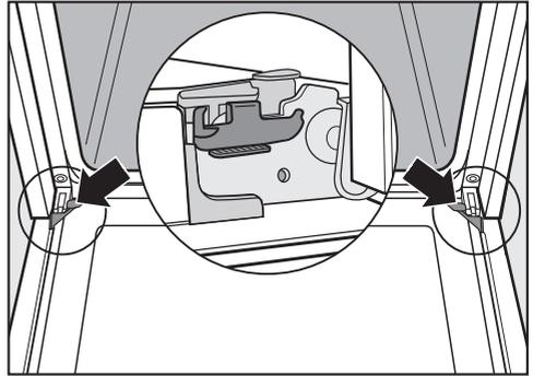
烤箱门通过夹持器与门铰链相连。从夹持器上拆卸机门之前，必须松开两个机门铰链上的锁紧夹头。
