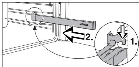
■ 将 FlexiClip 灵动滑轨钩在搁架层较低轨道的前部 (1.)，然后沿轨道将其推进烤箱内腔 (2.)。
