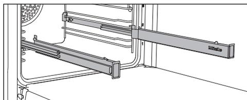
您可在搁架层 1-4 上使用 FlexiClip 灵动滑轨。
