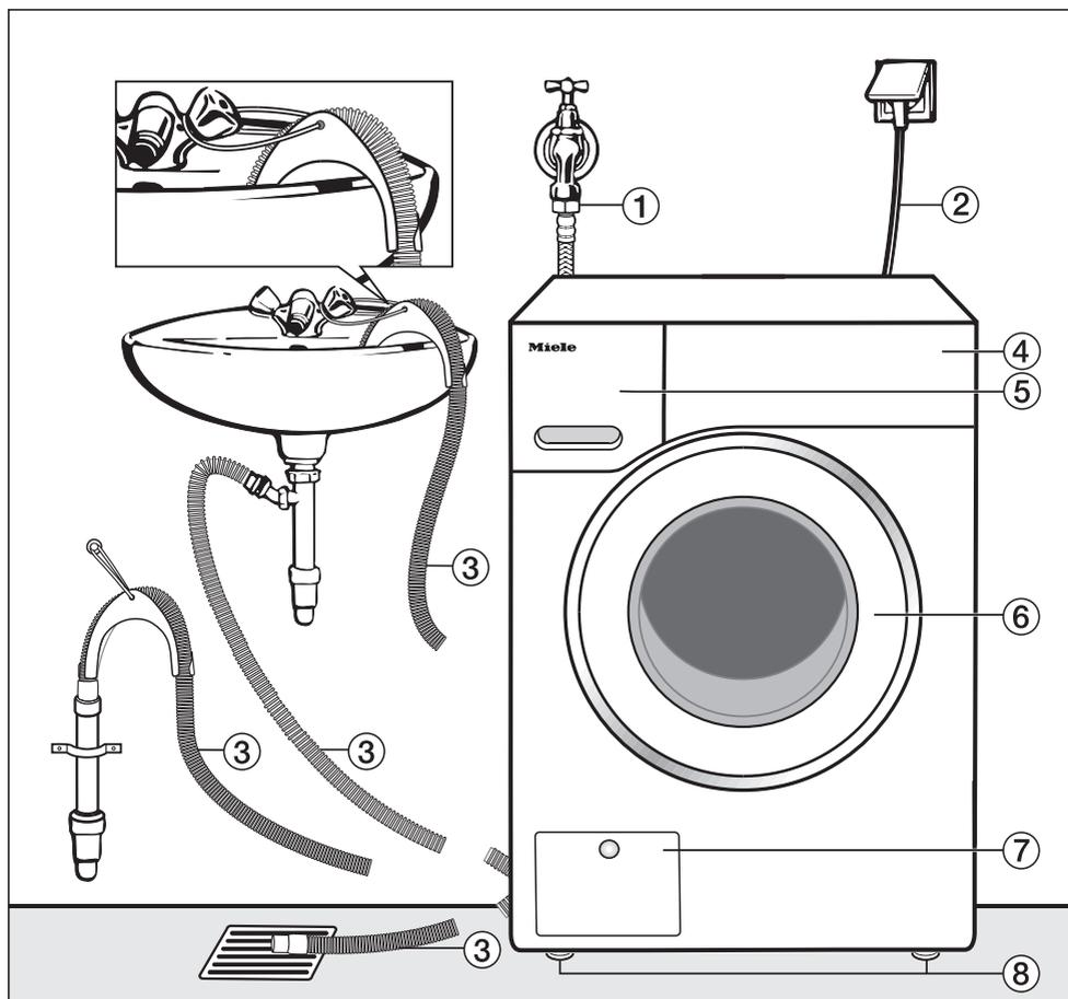
① Tuyau d'arrivée d'eau (WPM, Water-Control Metal, tuyau à armature métallique)
