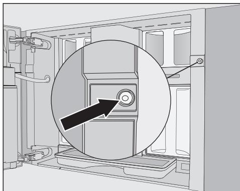
螺孔内有一个红色硅胶塞，用于在运输过程中固定电器机门，防止运输损坏。
