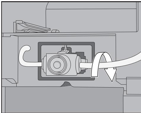
**提示:** 必要情况下, 将奶管转到右侧连接件的后面。
