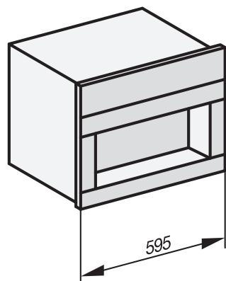
该电器可以与其他 Miele 嵌入式电器结合使用。如果要将咖啡机嵌入在另一个电器的上方，则二者之间必须放置一个全宽的封闭式中间搁架。如果该电器与食物保温机/嵌入式真空食物保温机结合，那么二者之间无需放置中间搁架。
