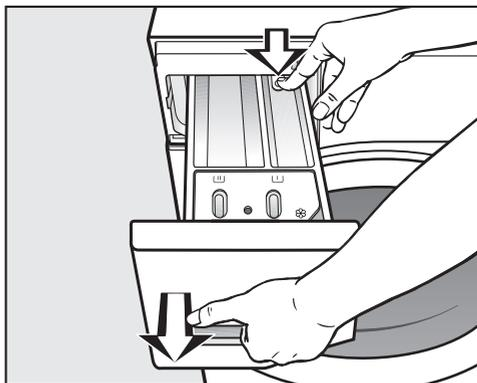
■ Sfilare il cassetto detersivi fino alla battuta, premere la testa di sbloccaggio ed estrarre del tutto il cassetto.
