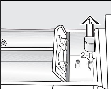
1. Sfilare il dispositivo di aspirazione dalla vaschetta ☼ e pulirlo sotto acqua corrente calda. Pulire anche il tubicino sul quale il dispositivo di aspirazione si innesta.
