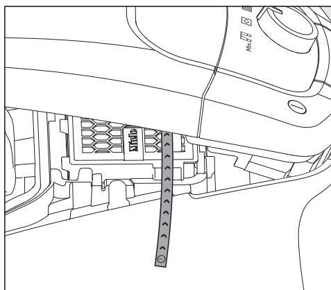
掃除機の集塵室の側面からサインのストリップが飛び出している場合、timestrip® フィルター交換サインを開始させる必要があります。
