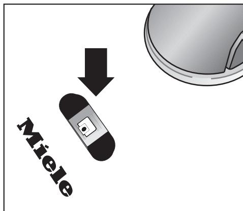
掃除機ダストバッグは掃除機ダストバッグ交換サインが満杯を示していたら、交換してください。
