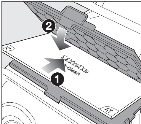
2. 排気フィルター **b** または **c** をフィルター **a** に付け替える場合は、フィルター用ホルダーの取り付けも必要になります\*。
