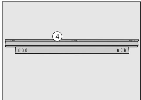
Para fixar o perfil de compensação, precisa do ângulo de fixação ④. Este está disponível na assistência técnica da Miele ou num distribuidor. O ângulo de fixação é montado na garrafeira:
