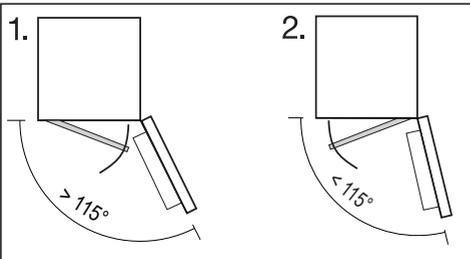
Un remplacement de la butée de la porte du compartiment de congélation est nécessaire en fonction de l'angle d'ouverture de la porte de l'appareil.
