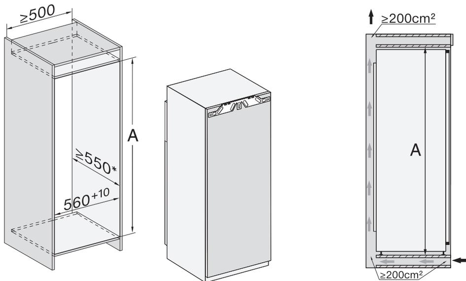
\* La consommation énergétique déclarée a été déterminée à partir d'une profondeur de niche de 560 mm. Avec une profondeur de niche de 550 mm, l'appareil de froid fonctionne parfaitement mais consomme légèrement plus d'énergie.
