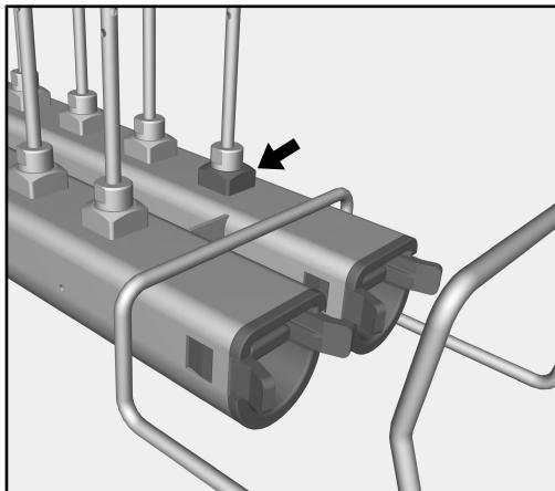
Den fremste holderen på den høyre injektorlisten brukes som kontrollpunkt for måling av spyletrykket. I forbindelse med ytelseskontroller og valideringer iht. EN ISO 15883, kan du måle spyletrykket her.
