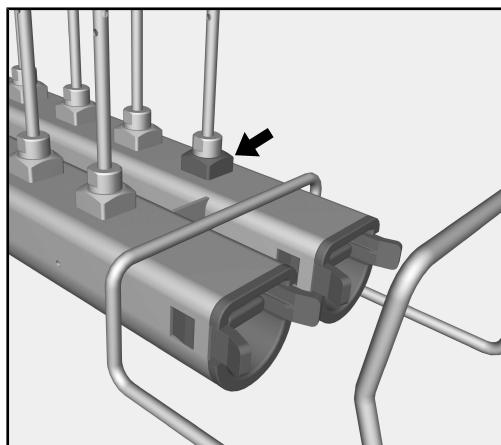
Il primo attacco del listello iniettore, visto dal tappo di chiusura di quest'ultimo, serve quale accesso per la misurazione della pressione di lavaggio. All'interno dei test sulle prestazioni di lavaggio e delle convalide ai sensi di EN ISO 15883 da questo accesso è possibile misurare la pressione di lavaggio.
