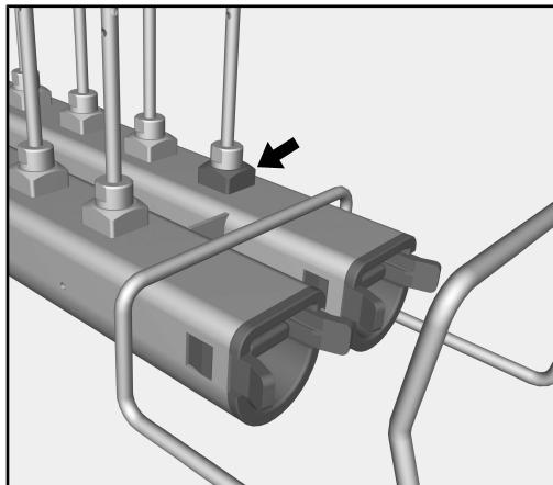
L'ouverture antérieure de la barre à injection de droite sert d'accès de mesure de la pression de lavage. Il a été établi dans le cadre du contrôle des performances et des validations en conformité avec la norme EN ISO 15883 que la pression de lavage pouvait être mesurée à cet endroit.
