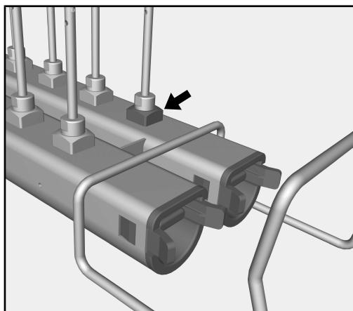
De voorste houder van de rechter injectorenheid dient als ingang voor de spoeldrukmeting. In het kader van prestatietests en validaties conform EN ISO 15883 kan via deze ingang de pompdruk worden gemeten.
