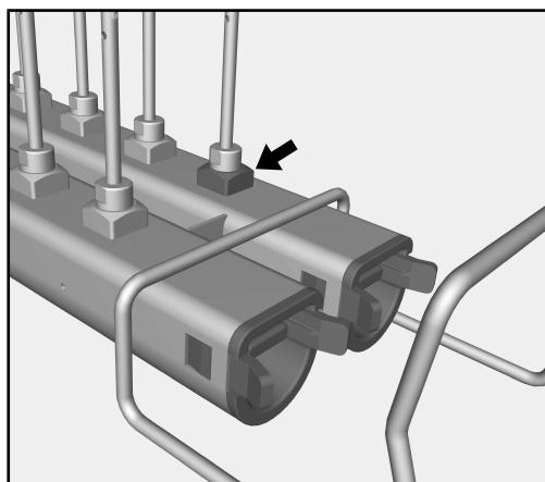
El alojamiento delantero de la regleta inyectora derecha sirve como acceso para medir la presión de lavado. En el contexto de las comprobaciones de potencia y validaciones conformes a la norma EN ISO 15883, en dicho acceso es posible medir la presión de lavado.
