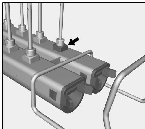
Den främsta hållaren på höger injektorlist används vid åtkomst till spoltrycksmätningen. Inom ramen för effektkontroller och valideringar enligt EN ISO 15883 kan spoltrycket mätas här.
