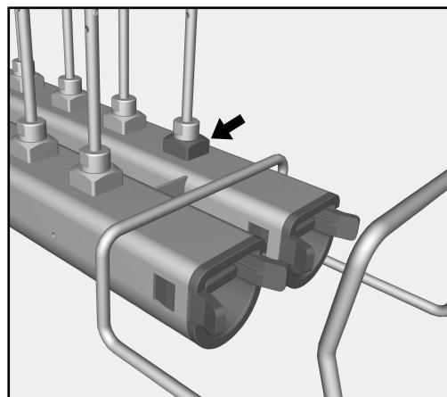
Den forreste holder i højre injektorliste anvendes til spuletryksmåling. Som led i afprøvninger af effekt og validering iht. EN ISO 15883 kan spuletrykket måles ved denne indgang.
