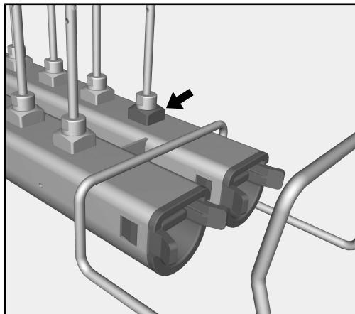
Sprednji nastavek desne injektorske letve služi kot dostop za merjenje tlaka pomivanja. V okviru preverjanja zmogljivosti in validacije po EN ISO 15883 lahko na tem dostopu merite tlak pomivanja.
