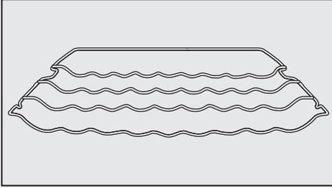
Die Flaschenablage können Sie variabel in das Kältegerät einsetzen.
