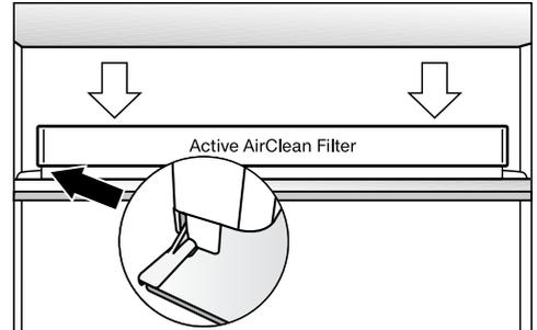
Dieser Geruchsfilter neutralisiert unangenehme Gerüche in der Kühlzone und sorgt somit für eine bessere Luftqualität.
