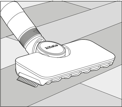
Šis plokščias ir lengvas grindų siurbimo šepetys labiausiai tinka siurbti po plokščiais baldais.
