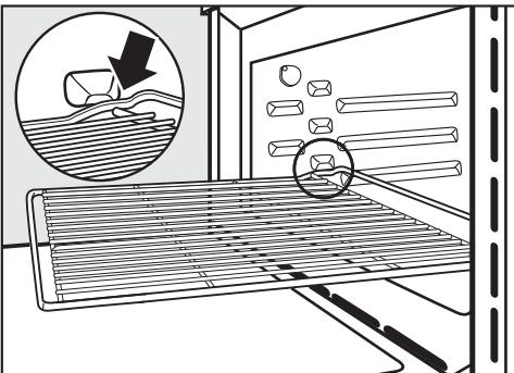
■ Čim rešetka prilikom izvlačenja udari sa zaštitom od izvlačenja, podignite napred malo rešetku.
