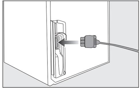
■ 将插头连接器插入制冷电器背面的插座。
