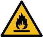
▶ 警告：火灾隐患/易燃材料。此符号位于压缩机上，表示易燃材料。请勿取下此标签。
