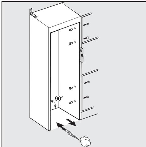
Mettez soigneusement la niche d'encastrement à niveau à l'aide d'un niveau à bulle avant l'installation de l'appareil de réfrigération. Les coins de la niche d'encastrement doivent être à un angle de 90° les uns par rapport aux autres, sinon la porte de l'armoire ne sera pas d'équerre aux 4 coins.
