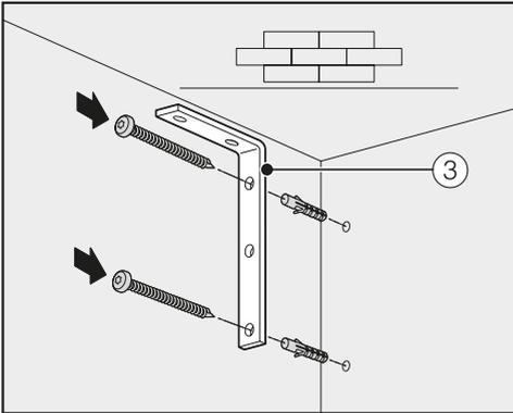
Fixation à un mur de béton
