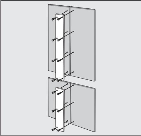
Si vous souhaitez installer deux façades l'une à côté de l'autre au lieu d'une seule, vous devez les joindre à l'aide d'une bande métallique.
