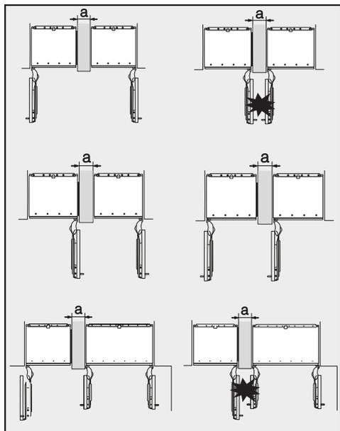
Si les charnières des appareils de réfrigération sont adjacentes, vous devez tenir compte de l'épaisseur des façades et des poignées de porte afin que les portes de l'appareil ne se heurtent et ne s'abîment pas si elles sont ouvertes simultanément.
