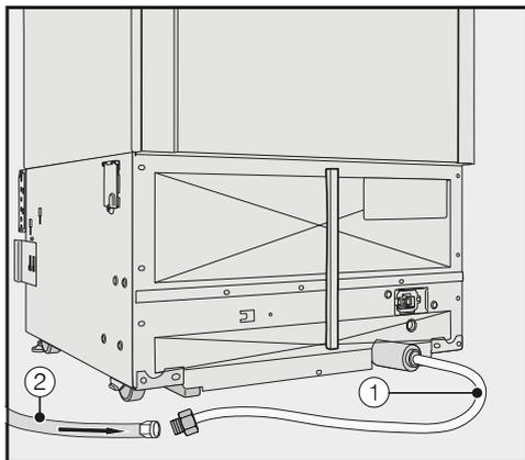
Le raccord d'eau ① est prêt à être relié à l'arrière de l'appareil de réfrigération.
