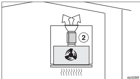
In caso di funzionamento a riciclo d'aria, l'insonorizzatore va installato tra il manicotto di sfiato e la griglia di sfiato ②. Controllare lo spazio per l'installazione.
