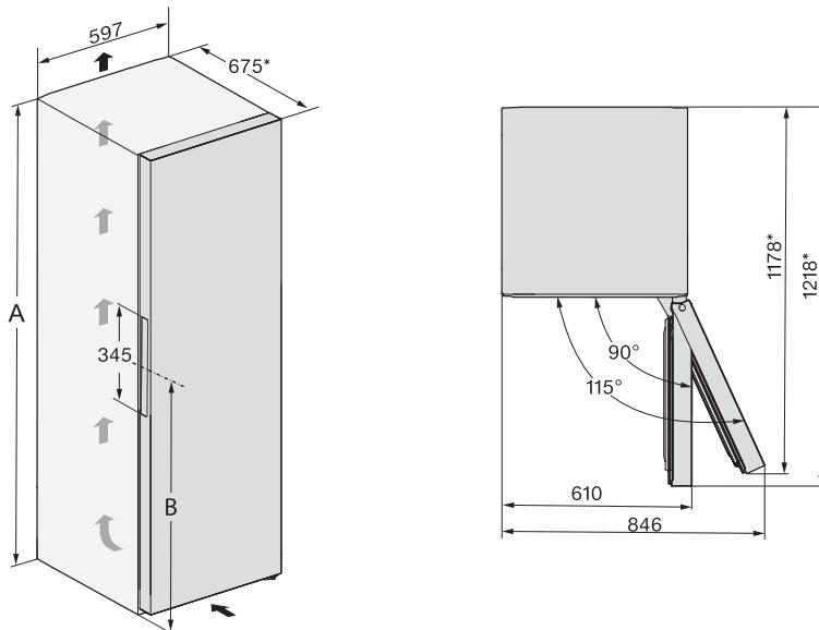
\* Dimenzijsa bez montiranog dodatka za odmak od zida. Ako se koriste priloženi dodaci za odmak od zida, dubina za ugradnju uređaja povećava se za 15 mm.
