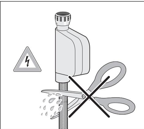
⚠ Stromschlaggefahr durch Netzspannung.
